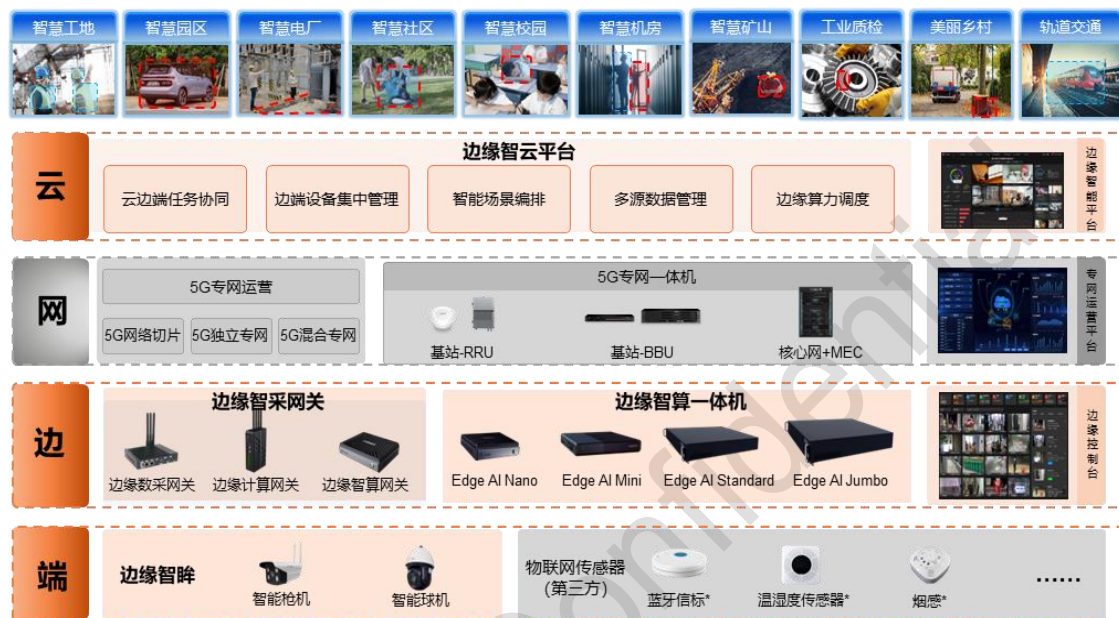
图 4-1 边缘智能产品整体架构
